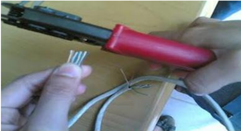
Meratakan Ujung Kabel
